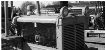
Griglie di protezione di organi in movimento quali cinghie, ventole di raffreddamento, ...
